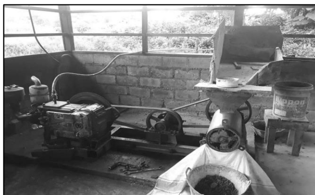
Gambar 3. Mesin Pembuat Pelet Ikan Sumber: Dokumentasi penelitian 2021
