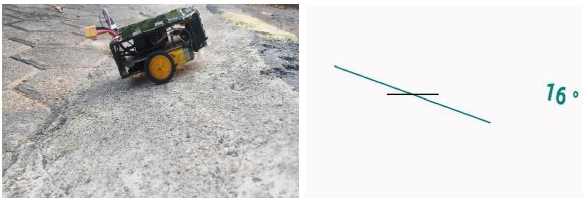
Gambar 1. Pengujian di kemiringan
