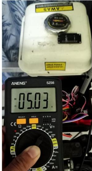
Gambar 2. Pengujian Catu Daya
