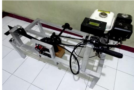
Gambar 4. Hasil Pembuatan Mesin Dynamometer
